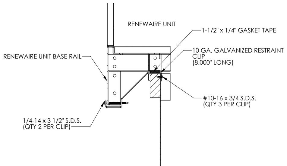
FIGURE 2.3.1 DN2 ERV ONLY CURB CLIP INSTALLATION
