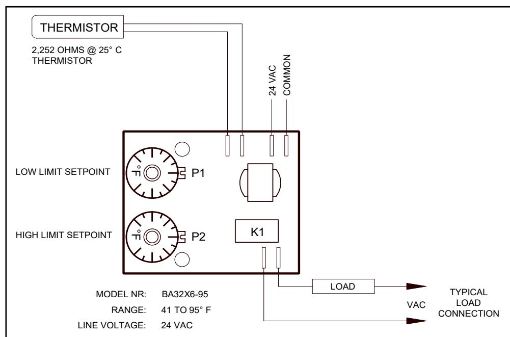
FIGURE 4.1.0 DRY BULB CONTROLLER PARTIAL WIRING SCHEMATIC
