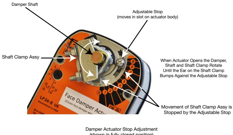
FIGURE 6.1.0 TYPICAL DAMPER ACTUATOR STOP ADJUSTMENT
