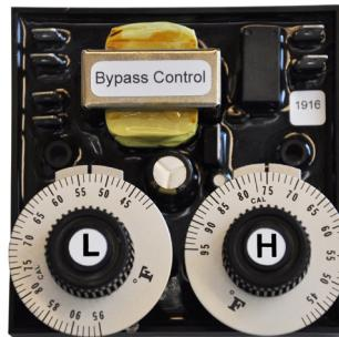
FIGURE 1.1.0 DRY BULB CONTROLLER
